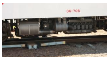
図6 DMF13HZ型エンジン
