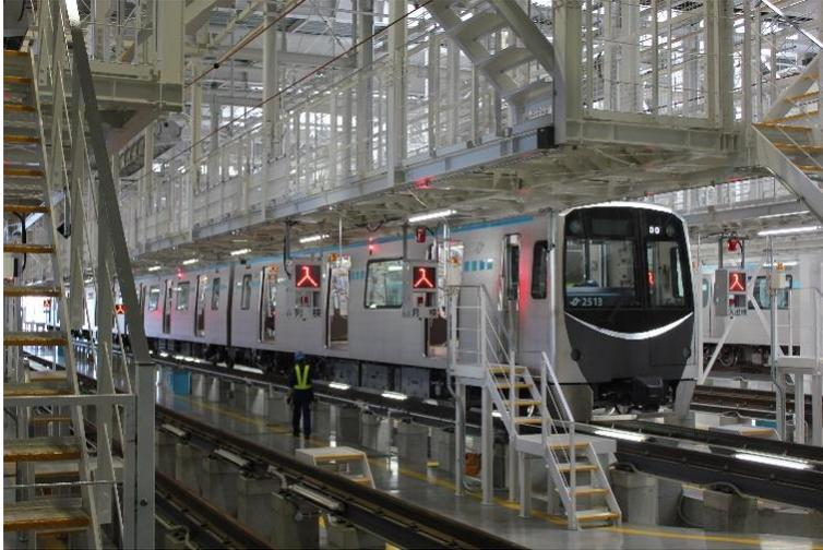
図2 検車エリアで列車検査を行っている車両
